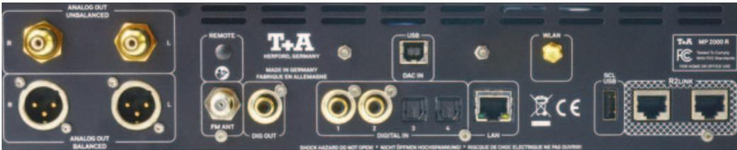
Hier fehlt nichts: Für den symmetrischen Anschluss liegen passende Kabel im Karton. Die D/A-Wandler-Sektion (Mitte) stellt ihre Fähigkeiten vier Zuspiegeln zur Verfügung (zwei optischen, zwei koaxialen). Etwas verwirrend: Die USB-Eingänge (Front und Rückseite) wählt man mit der „A-In“-Taste der Fernbedienung aus. Über R2Link nimmt der T+A mit Familienmitgliedern Kontakt auf.
