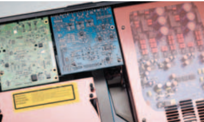
BILD UND TON PERFEKT: Der Genesis-Chip (oben) macht Progressive Scan; die Mehrkanal-Audio-Platine (unten rechts) mit Taktstabilisator stammt von T+A.
